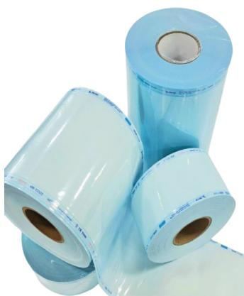
Bobinas planas sin fuelle para esterilización hechas de film PET/PP y papel médico 60 g/m<sup>2</sup>, con indicador químico que cambia de color; cumplen ISO 11140-1, son libres de plomo, compatibles con vapor, EO y formaldehído, resistentes al agua y la temperatura, y se sellan a 180 °C con selladoras estándar.
